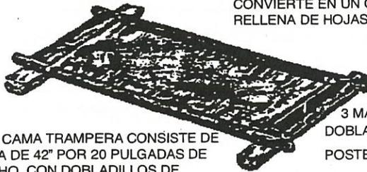
UNA CAMA TRAMPERA CONSISTE DE LONA DE 42" POR 20 PULGADAS DE ANCHO. CON DOBLADILLOS DE CUATRO PULGADAS A CADA LADO PARA LOS DOS POSTES.
